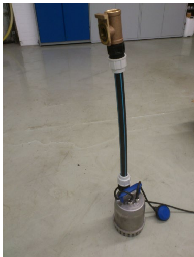
Pumpinredning monterad och klar.
