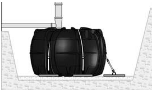
Förankring med förankringsplattor.
