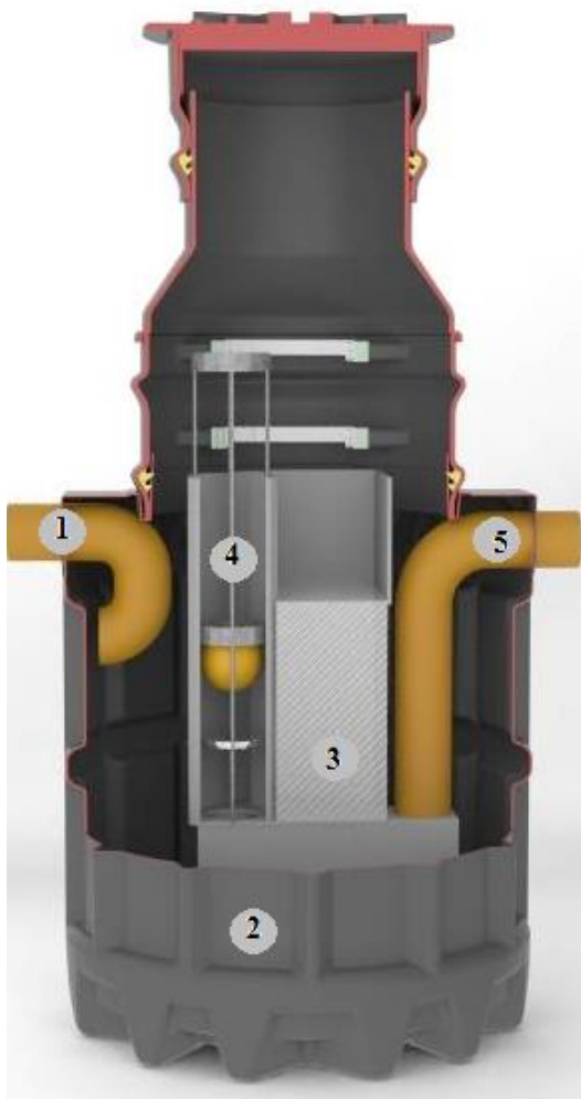
Fig.2. SEPKO oljeavskiljarens funktionsprincip
