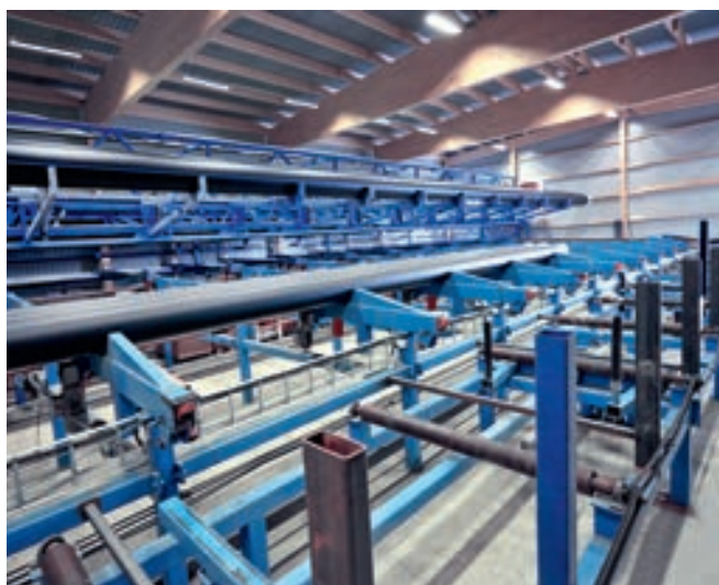
I en specialbyggd kassett i direkt anslutning till produktionslinjen, mellanlagras rören och får här möjlighet att stabiliseras ytterligare innan de buntas.
