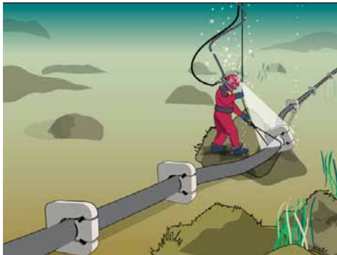
9. Specialutbildade dykare inspekterar och korrigerar ledningens läge...
