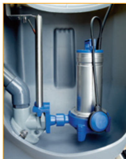
Stationär vått uppställd pump med gejdorr och kopplingsfot fastsatt i sumpbotten. När pumpen sänks ned längs gejdören låses den automatiskt mot kopplingsfoten. Bilden visar installation i en Flygt Micropac 7 pumpstation
