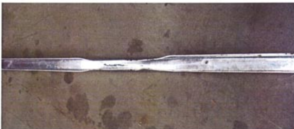
Bild 2. Deformerad U-profil i monteringsanordningen efter full provningskraft.
