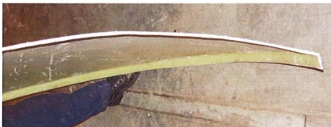
Bild 1. Tvärsnitt genom brunnsbetäckningen.
