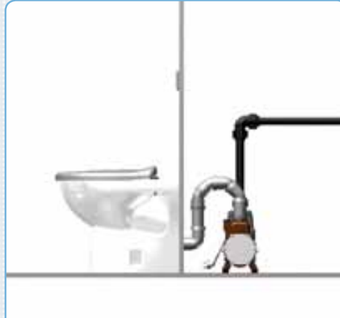
Pump monterad i anslutande rum
