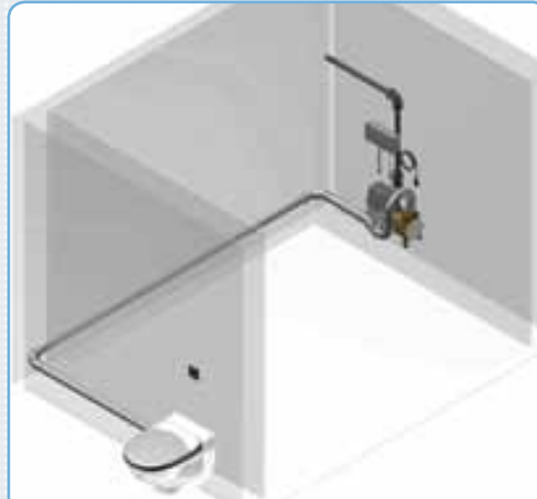
Pump monterad i ett annat rum, rör i vägg
