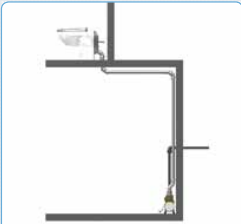
Pump monterad på bottenvåning
