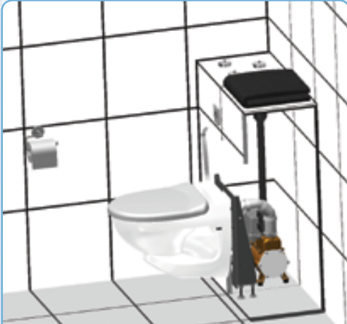
Pump monterad i box bakom toaletten
